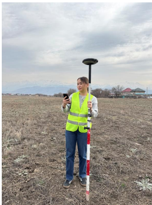
5 Сурет – №3 шекаралық нүктеге разбивка жасау сәті
